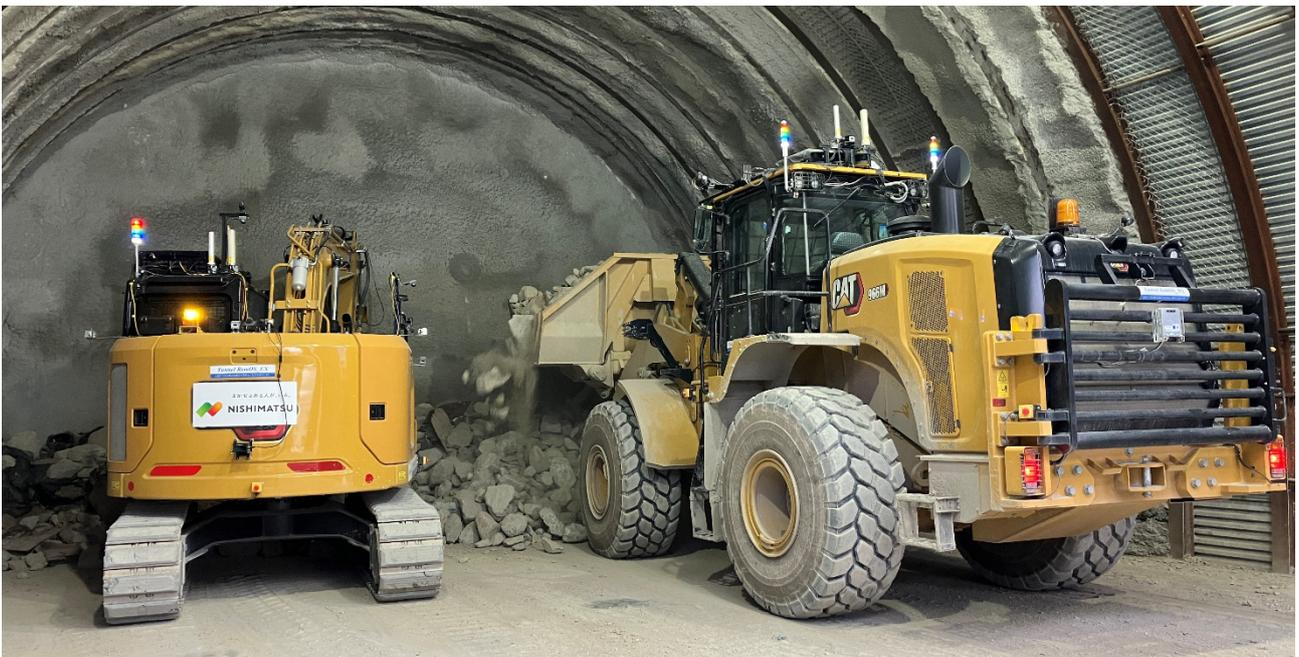
図1 自動化されたバックホウ（左）とホイールローダ（右）による作業状況
