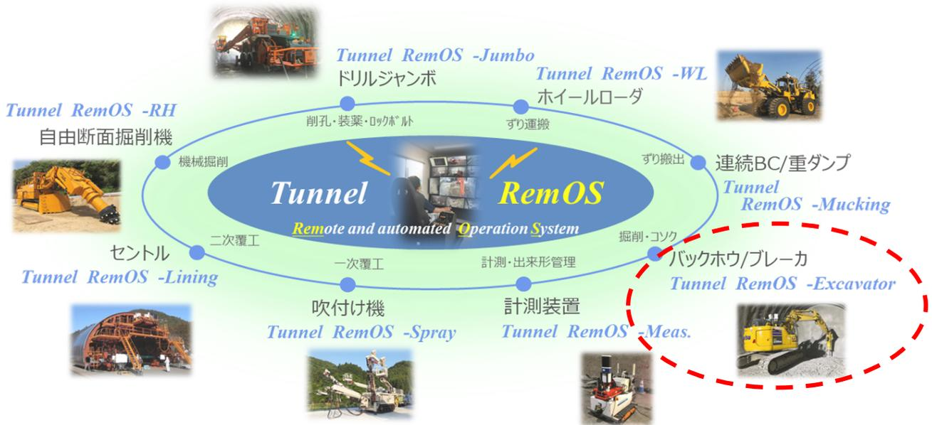
図2 山岳トンネル無人化・自動化施工システム『Tunnel RemOS』の構想図
